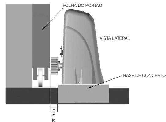
**3º Passo:** Atendidas as condições, abra totalmente o portão e posicione o automatizador próximo à face da folha do portão, obedecendo a medida de 50 mm entre a extremidade da folha e o automatizador.
