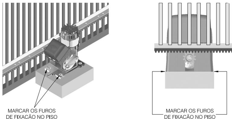
**5º Passo:** Faça a furação para a fixação, posicionando o automatizador alinhado ao portão. Antes de apertar os parafusos  $S \frac{1}{4} \times 2 \frac{1}{2}$ ", movimente o portão, verificando se o mesmo não encosta no automatizador no decorrer de seu percurso. Caso isso ocorra, recue o automatizador.
