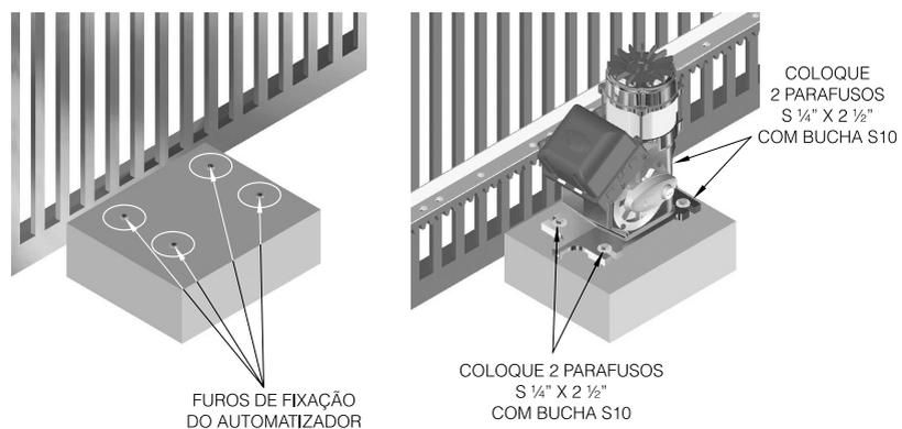
**6º Passo:** Com o automatizador destravado, posicione a barra de cremalheira sobre a engrenagem e alinhada ao portão.
