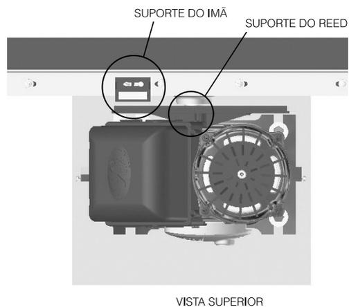
**3º Passo:** Acione o motor e observe se os REED's estão desligando corretamente. Caso haja necessidade, inverta o conector da placa. Depois de fixados os suportes dos ímãs, faça os ajustes finais, deslocando-os para a direita ou para a esquerda, conforme o ajuste desejado.
