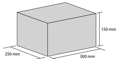
**2º Passo:** As dimensões da base deverão ser apropriadas para as dimensões do automatizador. A base de concreto deverá ficar a uma distância de aproximadamente 20 mm da face da folha do portão.
