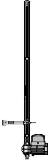
**2º Passo:** Remova a tampa superior do trilho e instale os suportes de fixação do lado oposto ao pino da porca acionadora.
