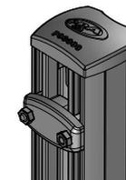
**6º Passo:** Posicione o automatizador verticalmente na coluna do portão e solde os suportes de fixação na coluna, respeitando as medidas da figura abaixo.
