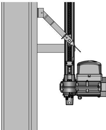
**9º Passo:** Com o portão fechado, mantenha uma inclinação de 50 mm na alavanca de tração, respeitando uma distancia do centro do ponto de giro da alavanca de tração e o centro do pino da porca acionadora.
