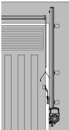
**7º Passo:** Encaixe a alavanca de tração no pino da porca acionadora do automatizador.
