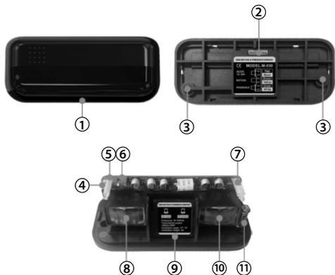
1-Filtro óptico | 2-Tomada para conexão | 3-Furo de parafuso para instalação | 4-Botão de ajuste de sensibilidade de micro-ondas | 5-Indicador de detecção de movimento por micro-ondas | 6-Seleto de saída de sinal NA/NF de presença | 7-Indicador de detecção de
