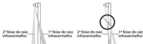
Ao ajustar a faixa de detecção de presença por infravermelho, a primeira linha pode ser ajustada acima do limite para evitar que a porta feche e as pessoas fiquem presas ao passarem.
