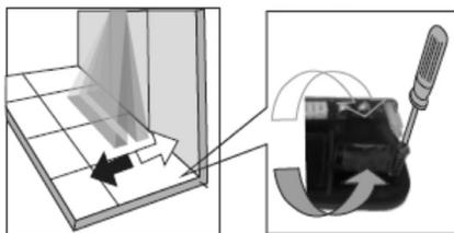
**NOTA:** Como a figura mostra, quando o botão é ajustado no sentido horário, a faixa de detecção será reduzida. Quando ajustado no sentido anti-horário, a faixa de detecção será aumentada.
