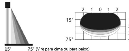
**OBS:** A configuração inicial de fábrica é 45 graus. O parâmetro acima é baseado em uma altura de 2.8 m. Todos os parâmetros desse manual são apenas referências e estão sujeitos às condições reais. A faixa de detecção será diferente de acordo com o material da porta e do piso. Ajuste a sensibilidade através do potenciômetro.
