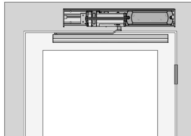
Se a porta for de abertura interna, fixe o automatizador de maneira que o braço de acionamento fique um pouco acima do topo da folha da porta.
