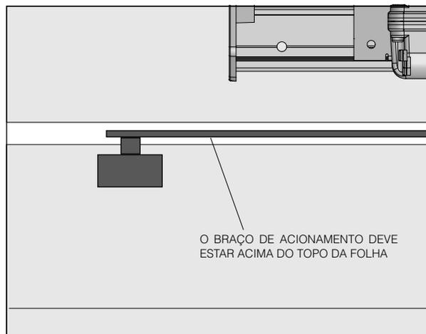
Se a porta for de abertura externa, fixe o automatizador de maneira que o braço de acionamento fique abaixo do topo da folha da porta.
