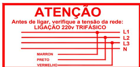
Adesivo de indicação da tensão elétrica, encontrado na extremidade do cabo elétrico de alimentação da máquina
